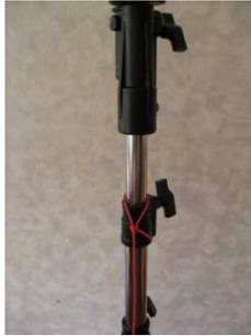
Nachdem die externe Anzeige aufgesetzt und festgeschraubt wurde, die Schleife hochschieben, bis sie – wie abgebildet zwischen dem Stativrohr und dem Metallteller des Befestigungsbolzens liegt. Mit dieser Schnur wird die externe Anzeige nach vorne abgespannt, daher muss die Öse auf der gleichen Seite des Stativs sein, wie die Anzeigenseite des Displays.
