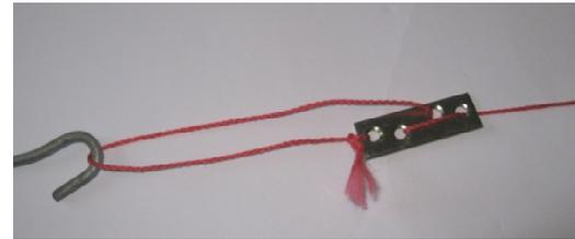
Kordel durch Verschieben des Metallstreifens spannen
