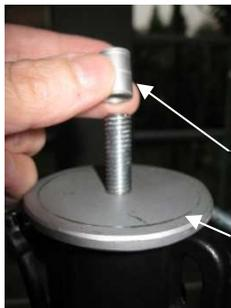
Kugelkopf fest aufschrauben (dabei **nicht** die große Bolzenmutter am Stativ lösen)
