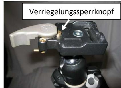
Die Frontkamera wird so auf den Befestigungsteller aufgesetzt, dass die Rückseite der Kamera zur Federklemme gerichtet ist und die Vorderkante des Befestigungsfußes unter die vordere Kante des Befestigungstellers „greift“
