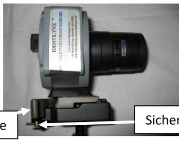
Damit die Kamera nicht versehentlich gelöst werden kann, sollte der Sicherungstift wieder zur „Seite“ gedreht werden.
