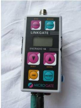
Das Funkstartsystem wird durch einen Druck auf die Taste ON/OFF des Senders in Betrieb genommen.
