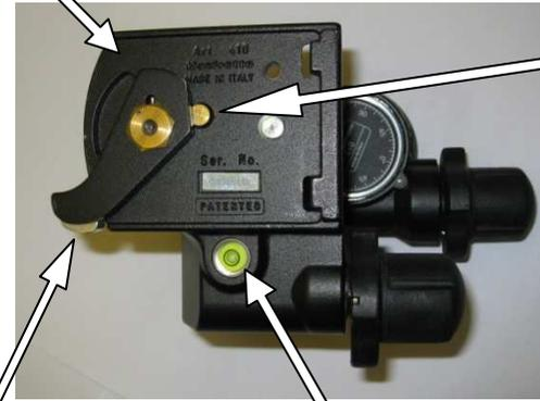
der „goldene“ Knopf muss heruntergedrückt werden, um den Hebel von der Position „offen“ manuell in die Position „verriegelt“ bringen zu können
